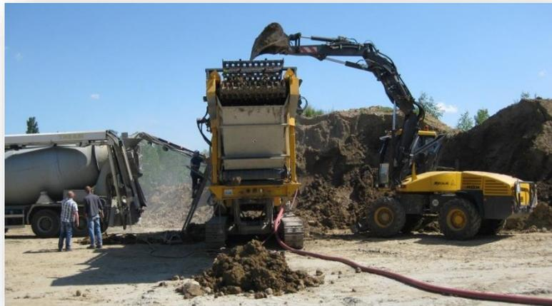
Bodenaufbereitung durch Sternsiebzanlage
